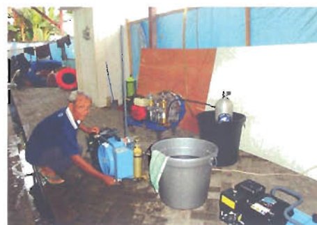
De 40 duikflessen worden dagelijks gevuld door de heer Sumadijo met behulp van drie compressoren.
